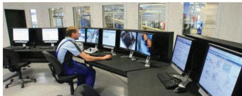
nico numa sala com monitores controla toda a fábrica, que destrói o pneu e separa lonas de aço e de nylon, pó de borracha, em vários tamanhos”, detalha Valter Armonas.
